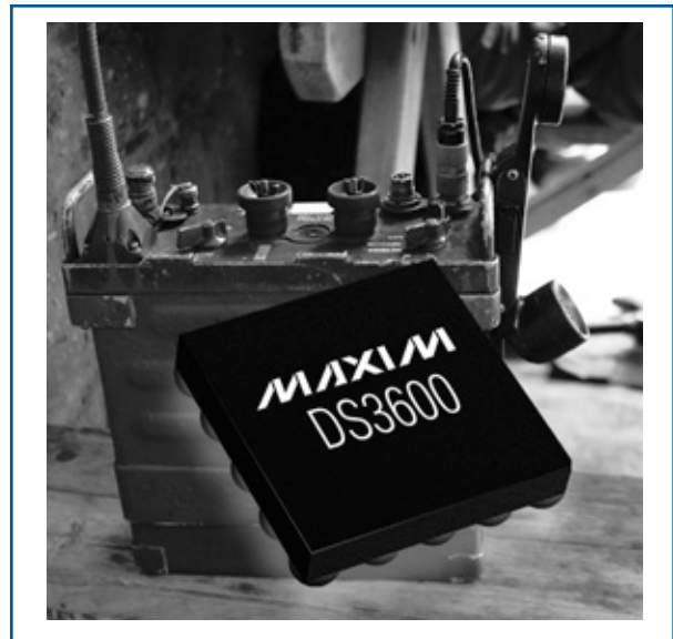
図3. DS36xxファミリのCSBGAパッケージは、デバイスを回路基板に取り付けるとI/O信号へのアクセスを制限し、パッシブな保護機能として働きます。
