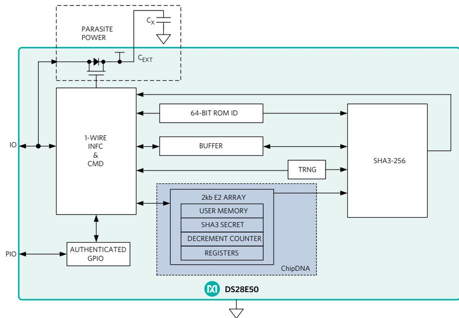
Figure 1. DS28E50 functional diagram
