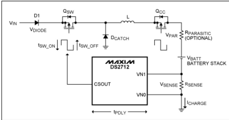
Figure 1. The DS2712 switching reference circuit.
