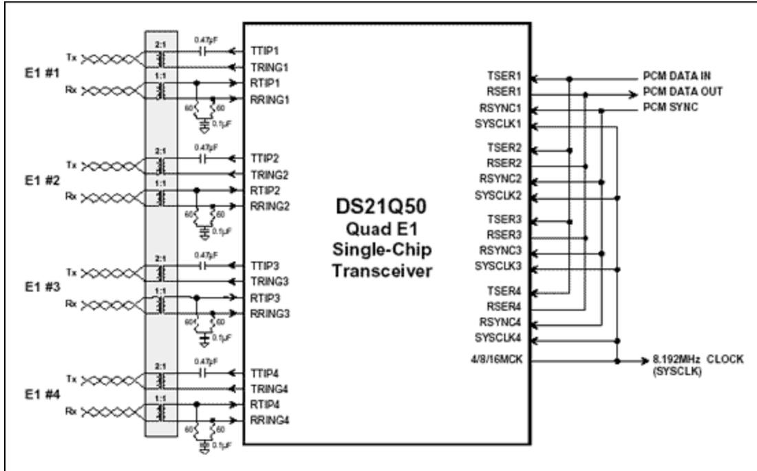
Figure 1. Four port E1 transceiver using DS21Q50.
