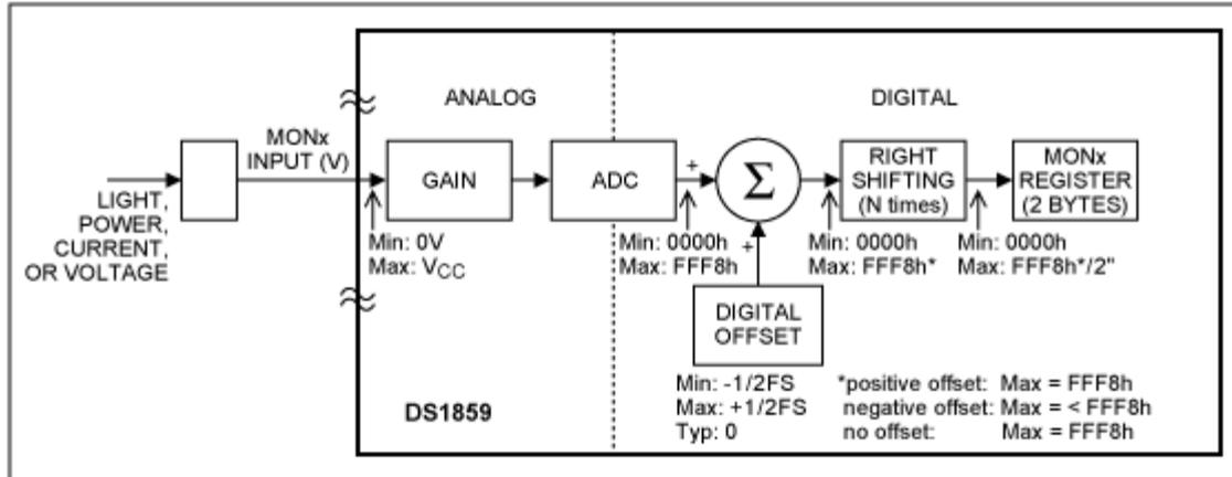
Figure 1. DS1859 MON input block diagram.
