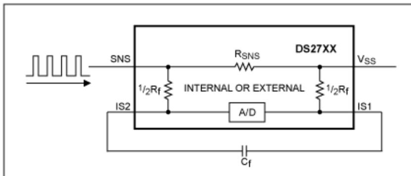
Figure 1. DS27XX A/D Filter Circuit.
