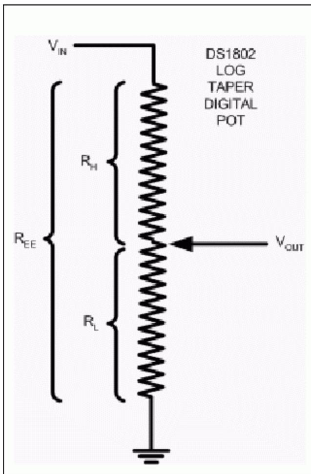
Figure 1. DS1802 block diagram (one potentiometer shown).
